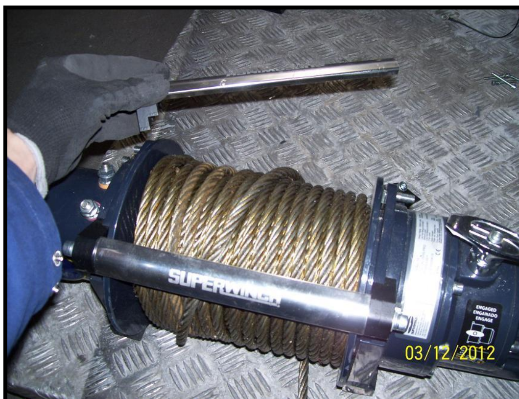
Demontaż tylnej listwy wciągarki Removing the rear bracket of the winch
