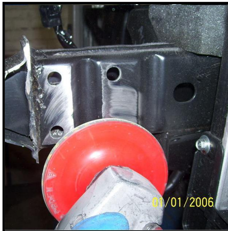
Wiercenie otworów \text{\O}13 i szlifowanie z obu stron The hole drilling \text{\O}13 and grinding from both sides
