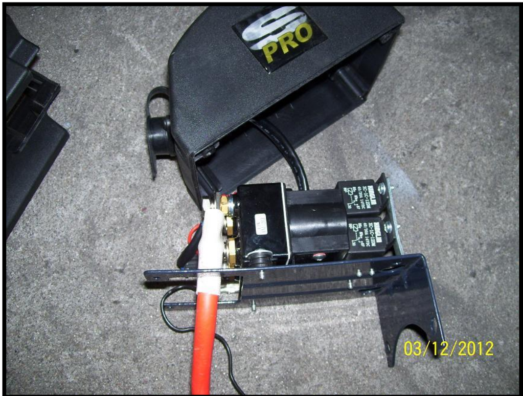
Montowanie puszki przekaźnika i wiercenie otworu \text{Ø}7 (x2) Mounting the relay box and hole drilling \text{Ø}7 (x2)
