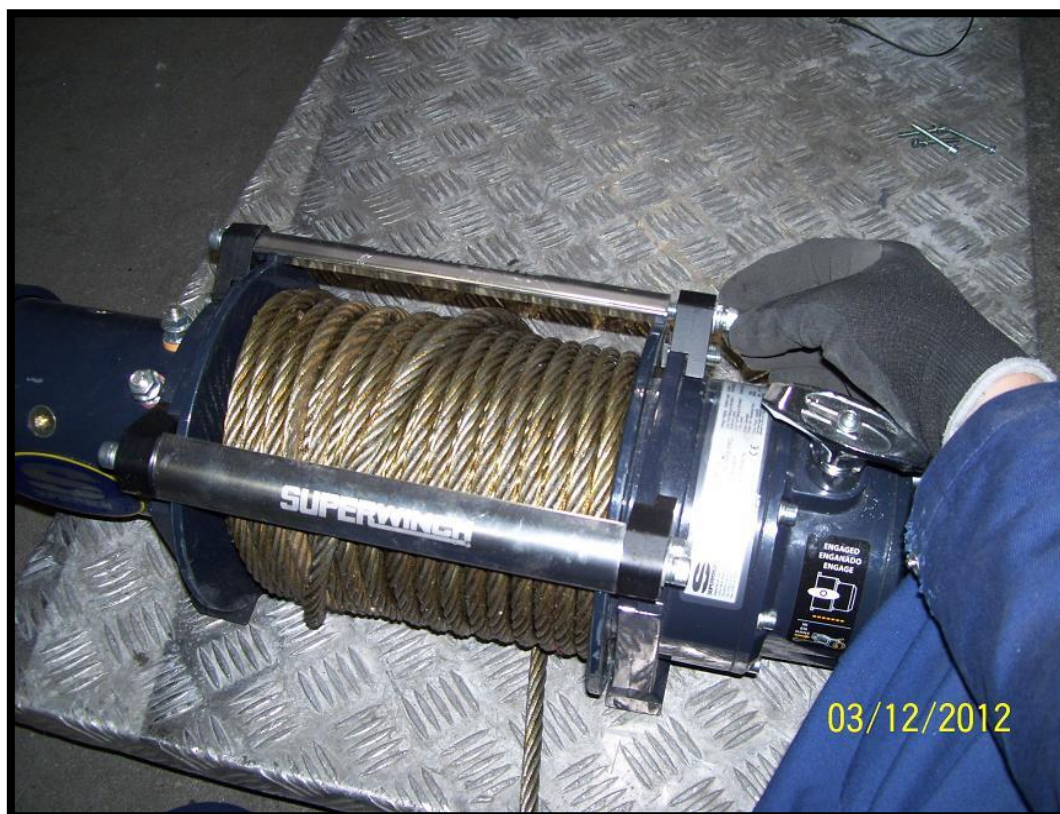
Demontaż tylnej listwy wciągarki Removing the rear bracket of the winch
