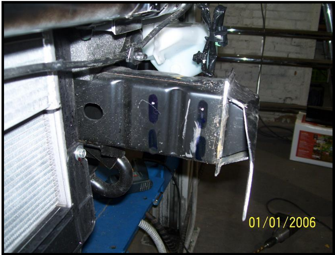
Napunktowanie przed wierceniem Scoring before drilling
