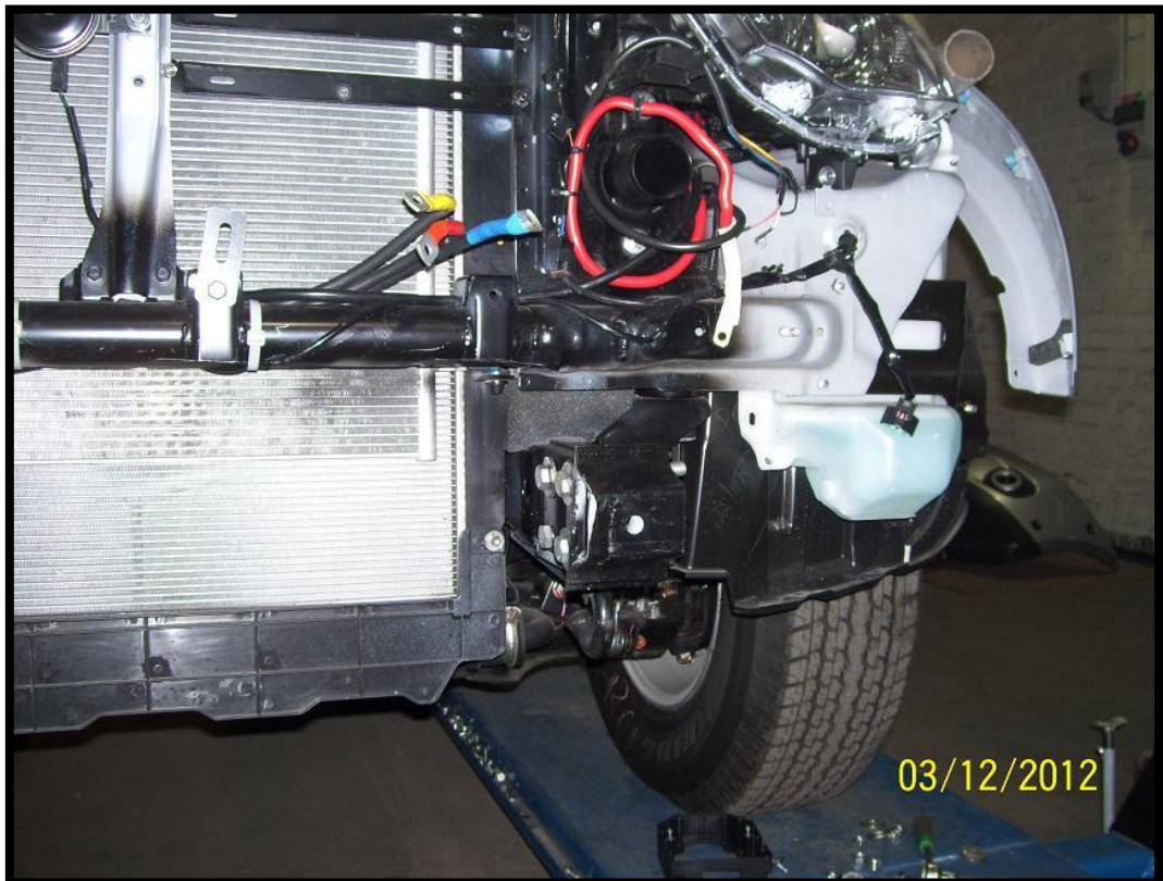
Wycinanie lewej części belki przedniej: Cut in the left part of the front beam:
