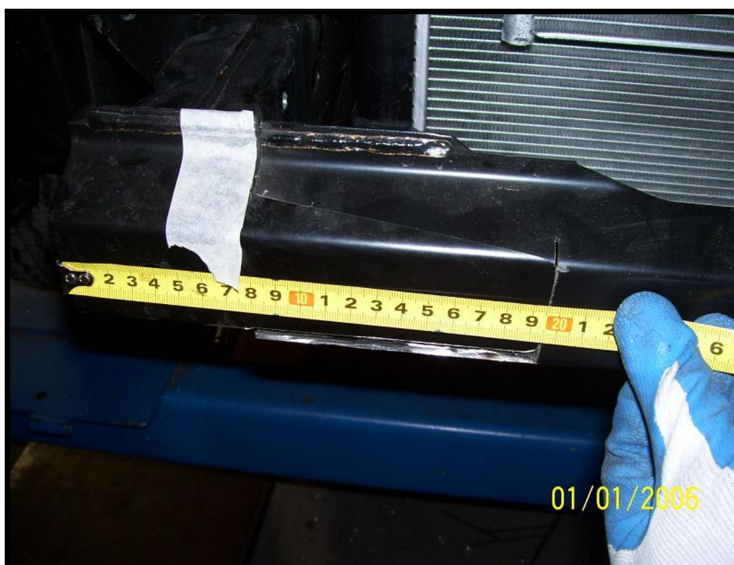
Wycinanie prawej części belki przedniej: Cut in the right part of the front beam:
