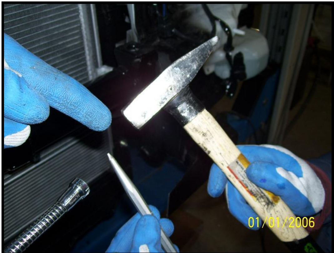
Napunktowanie przed wierceniem Scoring before drilling
