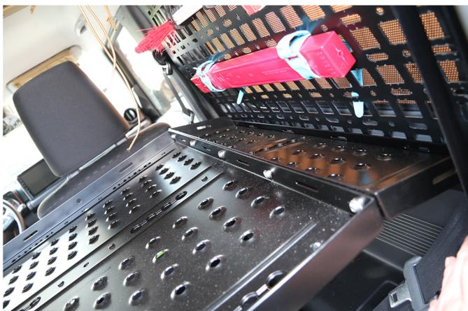
**Die Schrauben bitte noch nicht final festziehen, die Seitenteile sollen sich noch bewegen lassen. Wenn beide Seitenteile angeschraubt wurden kann man das Ablageblech dazwischen schrauben, also die kurzen Schrauben einfädeln, Unterlegscheiben nicht vergessen und Stopmuttern draufdrehen und fest anziehen. Zum Schluss dann die Schrauben der Seitenteile fest anziehen, FERTIG!**
