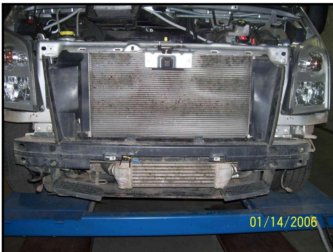
Wycinanie pasa przedniego może odbywać się na samochodzie lub po jego demontażu. Cut of the front beam can be carried out on the car or after its removal.
