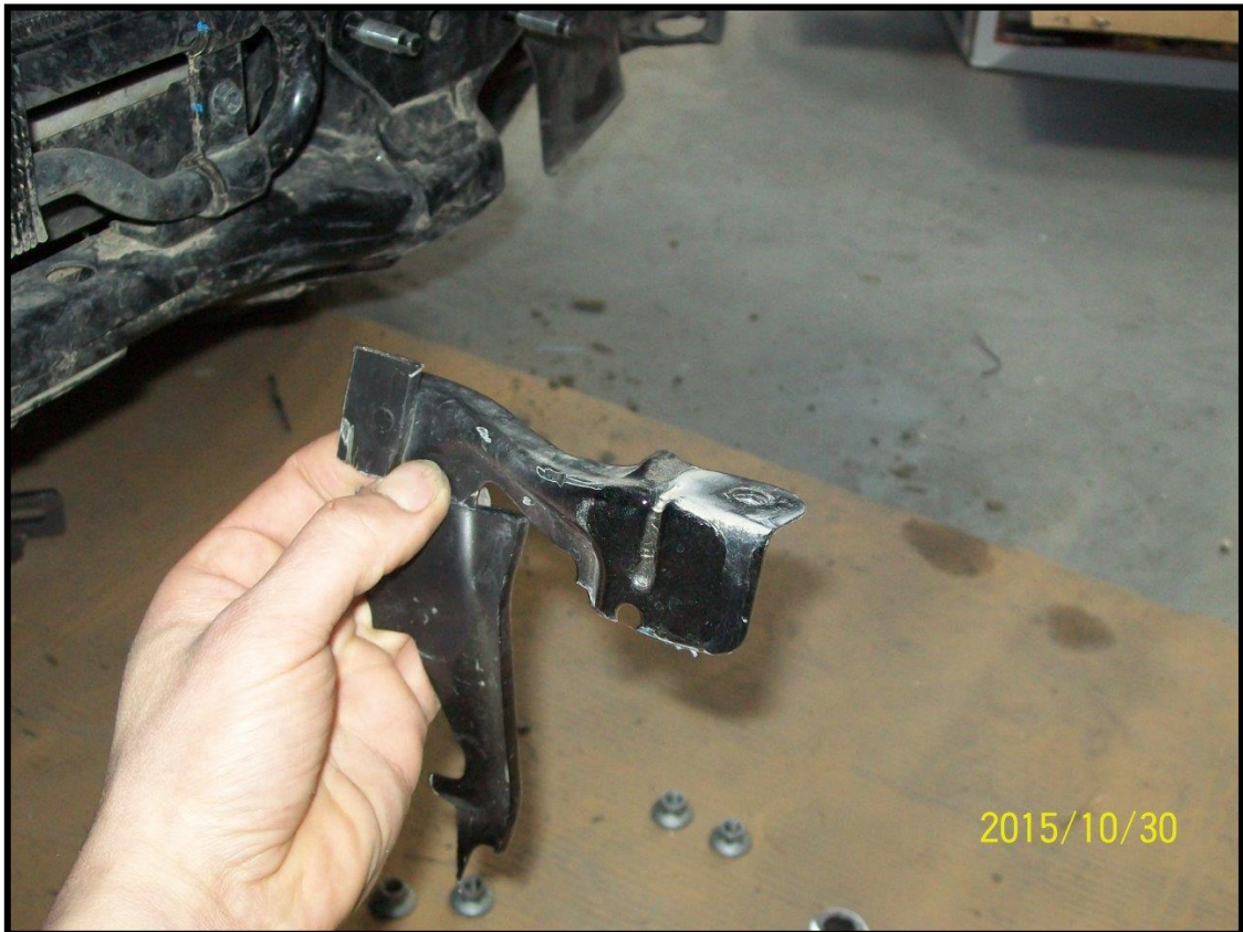
Wykonanie wycięcia w środkowej podporze. Performing notches in the central support.
