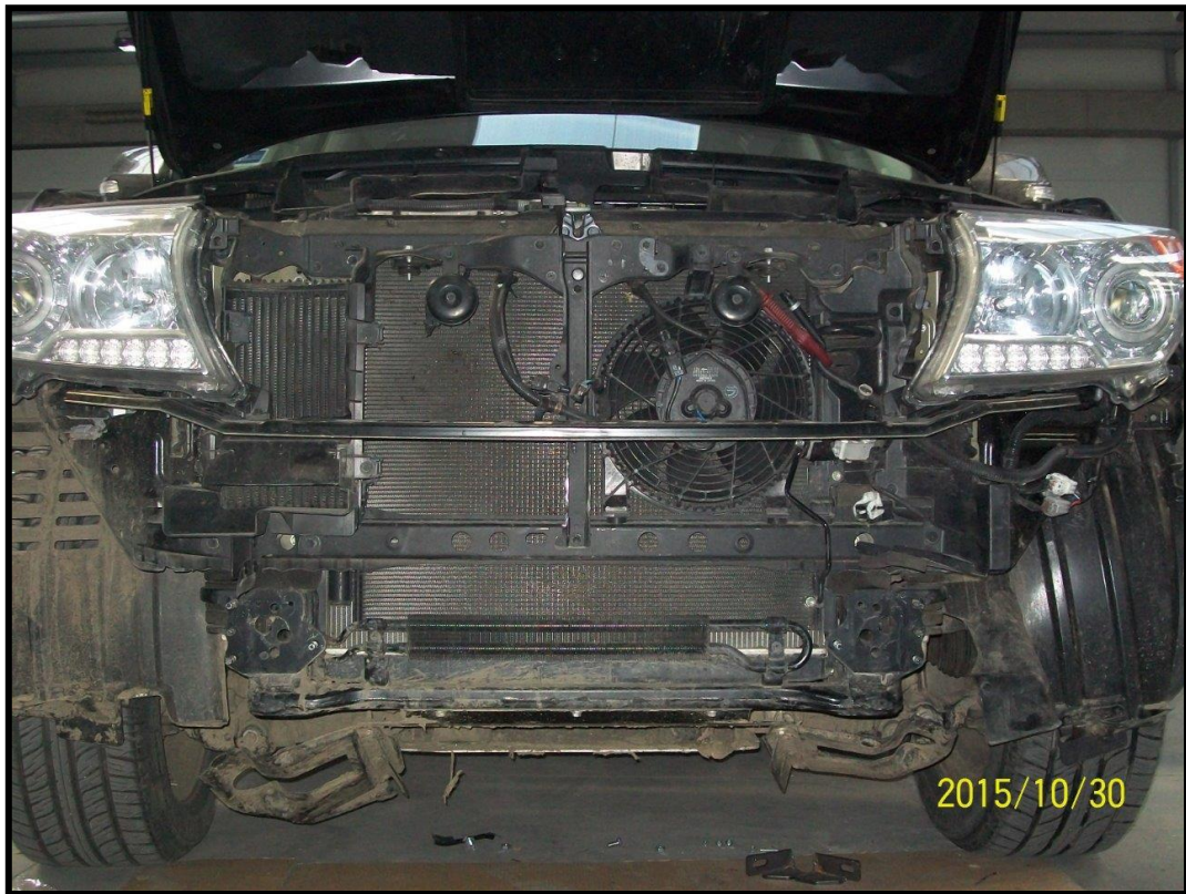
Wymontowanie belki przedniej. Removing the front beam.
