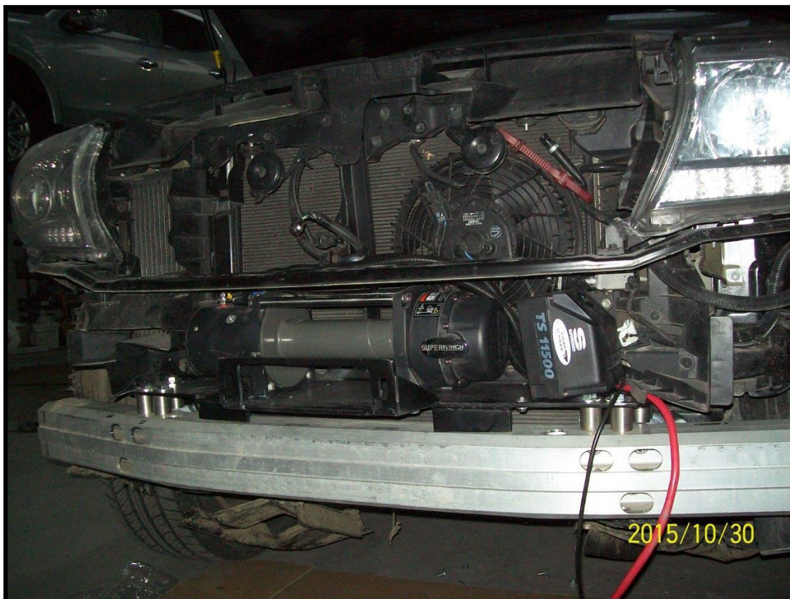
Montowanie wyciągarki i przekaźnika. Trzy przewody (H07V-K 1x35) z końcówkami (8x35). Mounting the winch and relay. Three wires (H07V-K 1x35) and tips (8x35).
