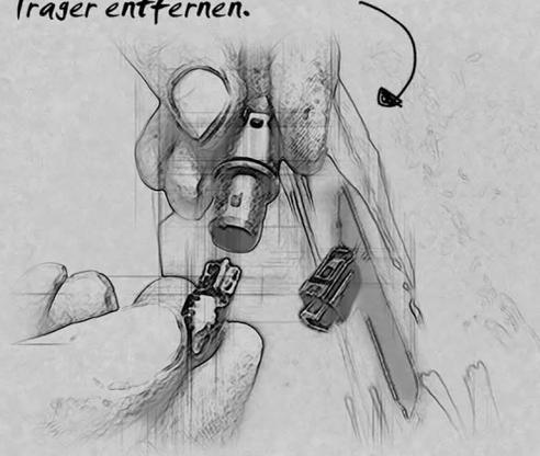
3. Den Stecker des LED-Blinkers in den Birnchenträger einstecken und die Blinkerfunktion testen. Sollte die Funktionalität nicht gegeben sein, den Stecker mit geänderter Polarität nochmals einstecken.
