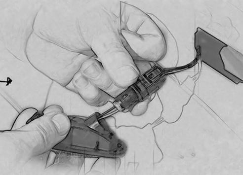
5. ...durch eine Drehung um 90° arretieren. Der LED-Blinker kann nun in den Kotflügel eingesetzt werden.
