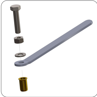
Abb. 12: Detailansicht Setzwerkzeug / detailed view of rivet tool
