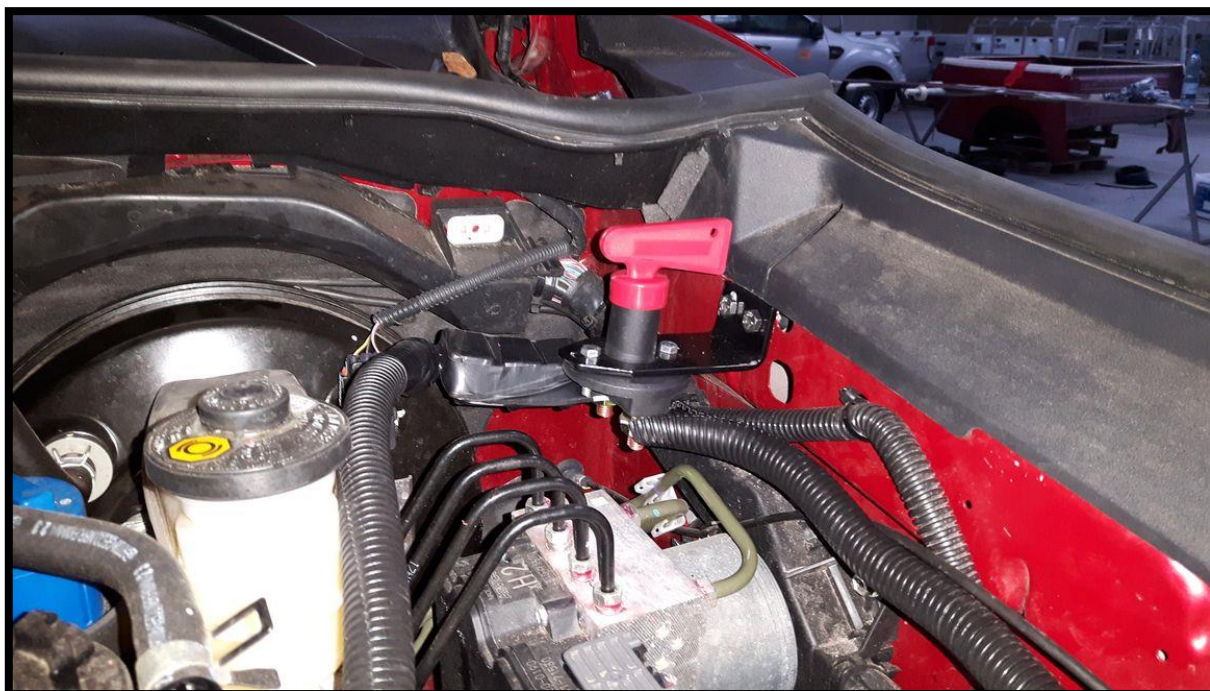
Montowanie pilota oraz hebla zabezpieczającego (główny wyłącznik prądu). Mounting the control switch and the security main breaker.
