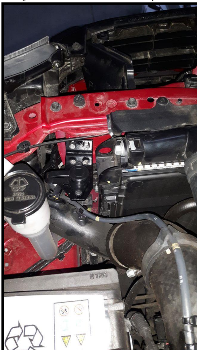
Montowanie pilota oraz hebla zabezpieczającego (główny wyłącznik prądu). Mounting the control switch and the security main breaker.
