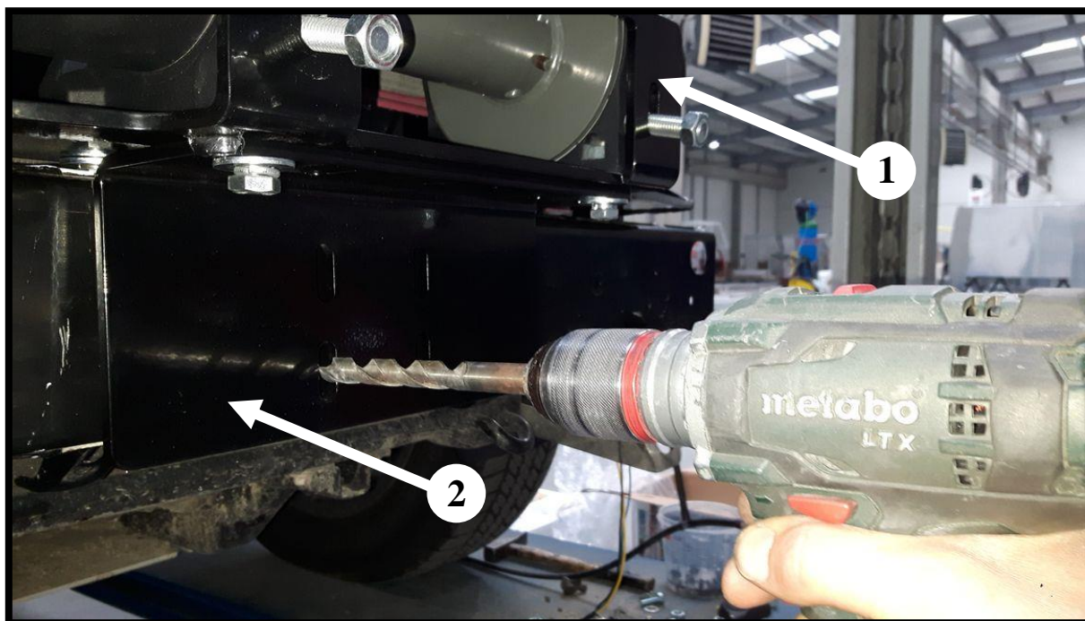
Do śrub M10 należy wywiercić otwory \text{Ø}11 . Hole drilling \text{Ø}11 for M10 screws.
