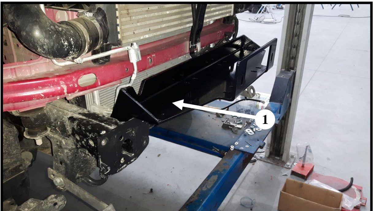
Ustawienie płyty wyciągarki Setting the winch plate
