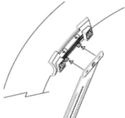
Schritt 2: Ziehen Sie das Montageband so fest wie möglich an und rasten Sie es dann in 2 vorgesehene Löcher ein. Fixieren Sie das Montageband mit 2 Schrauben. Verwenden Sie eine Schere, um das überstehende Montageband zu entfernen.
