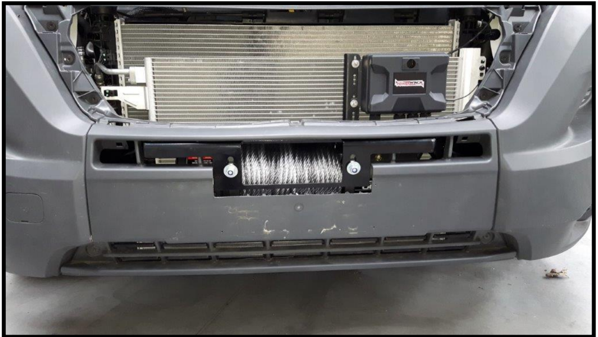
Dopasowanie i montowanie przedniej osłony wlotu powietrza. Adjusting and mounting the front airflow cover.
