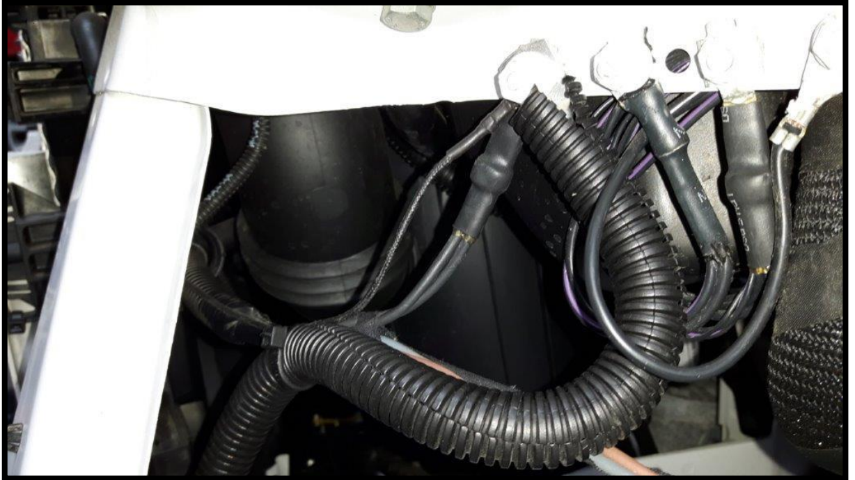
Trzy przewody (H07V-K 1x35) z końcówkami (8x35). Three wires (H07V-K 1x35) and tips (8x35).
