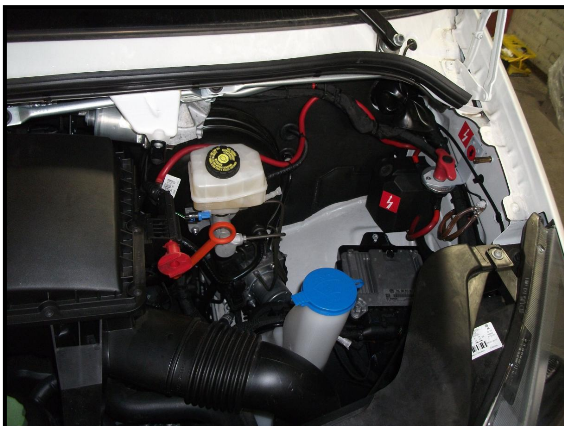
Hebel zabezpieczający (główny wyłącznik prądu) montuje się w dowolnym miejscu pod maską. Security main breaker is mounted anywhere under the hood.
