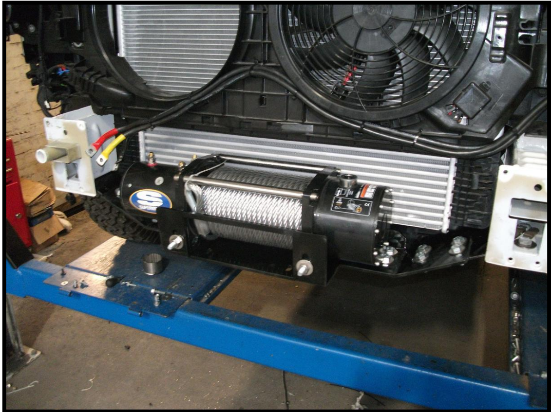
Montaż wciągarki Winch assembly
