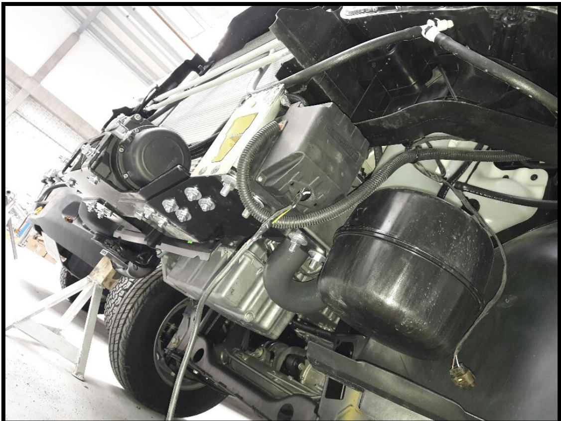
Montowanie przekaźnika – ustawić jak najdalej w głąb samochodu. Mounting the relay – set as far into the car as possible.
