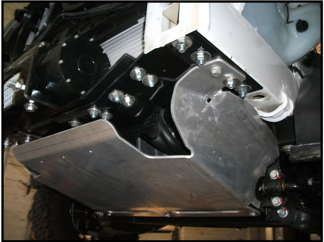
Montaż dolnej osłony i końcówki Installation of the bottom cover and terminal
