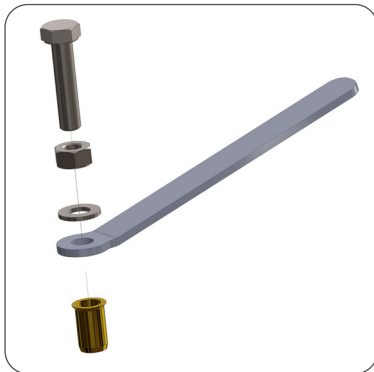
Abb. 12: Detailansicht Setzwerkzeug / detailed view of rivet tool
