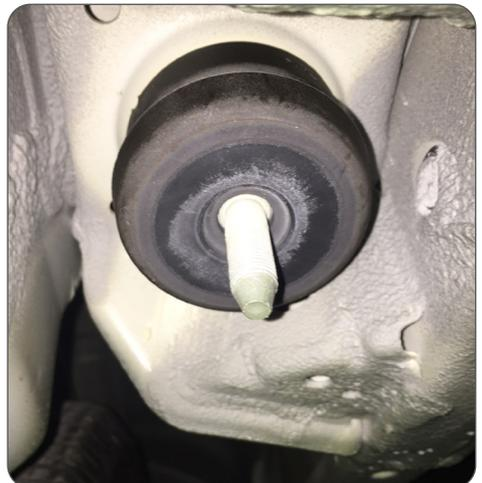
Abb. 03: Verschraubungspunkt ohne Karosseriescheibe / mounting point without body washer
