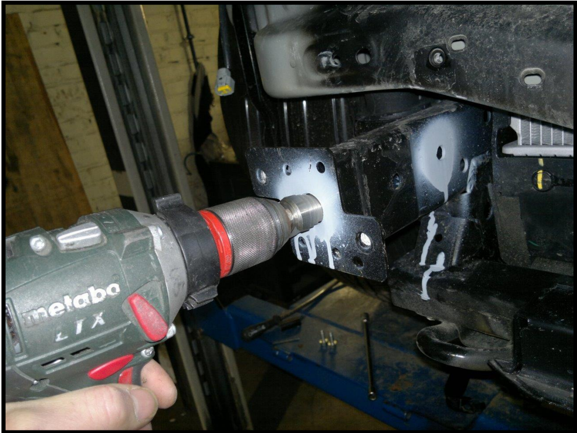
Rozwiercenie otworów \varnothing 13 z boku. Hole drilling \varnothing 13 from side.
