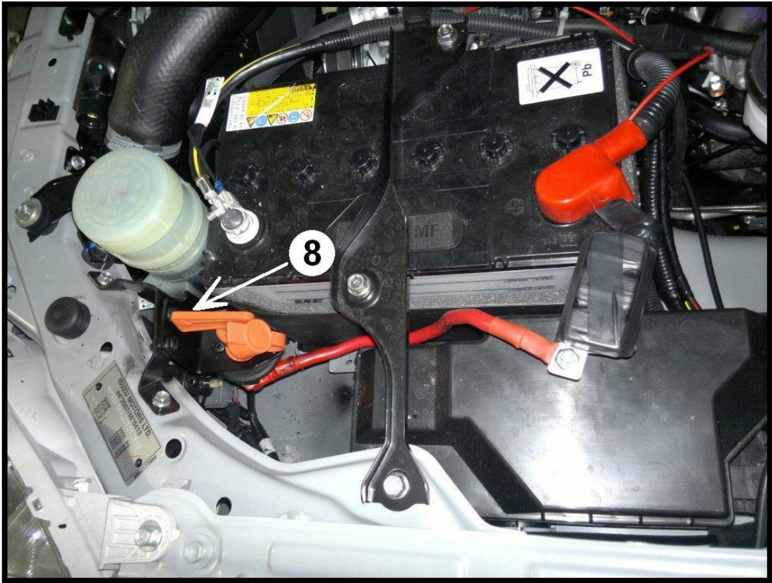
Montowanie zamocowania gniazda. Mounting socket attachment.
