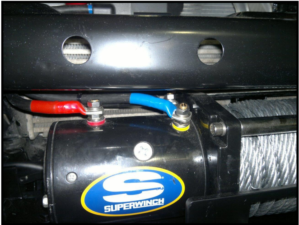
Trzy przewody (H07V-K 1x35) z końcówkami (8x35). Three wires (H07V-K 1x35) and tips (8x35).
