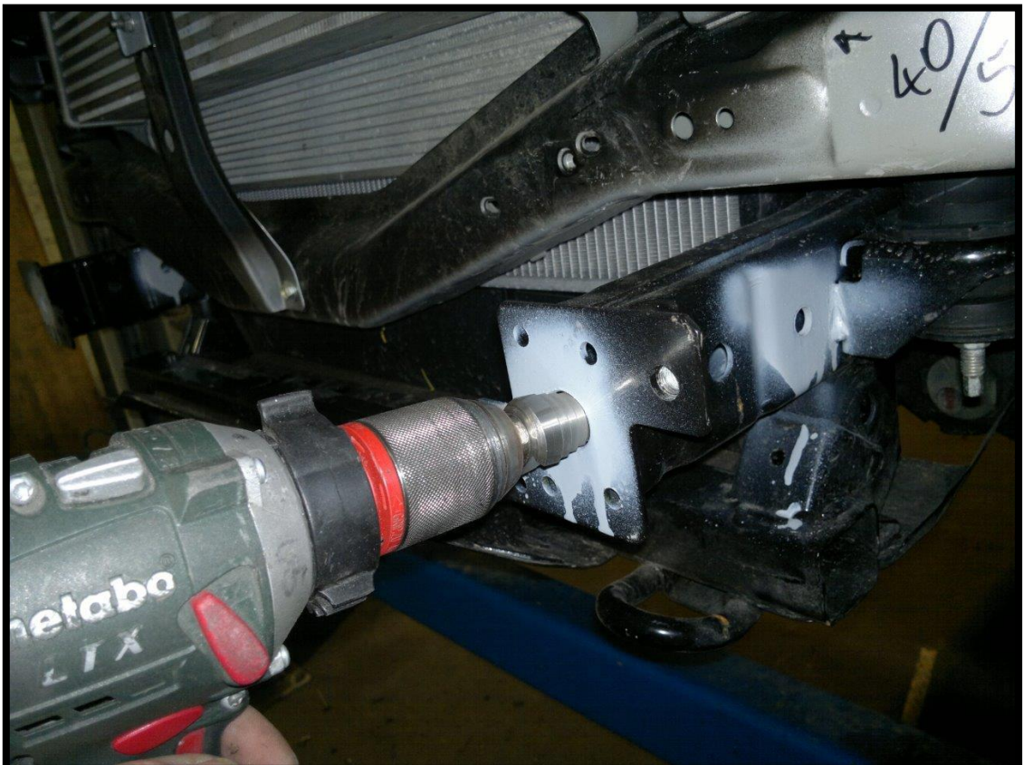
Wiercenie otworów Ø22 Hole drilling Ø22
