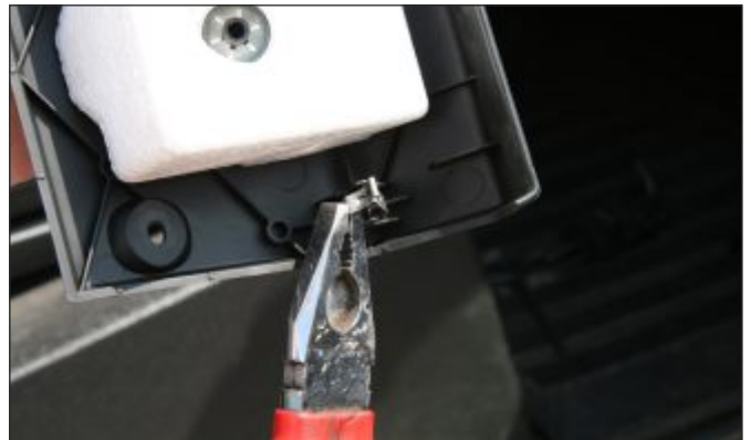
2. Halteklammern und Styropor entfernen
