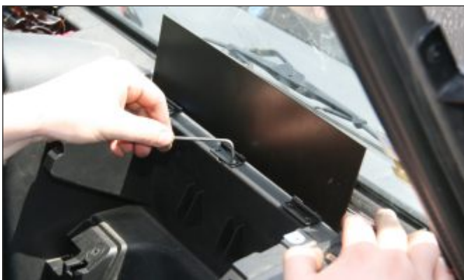
5. Montageplatte positionieren und anschrauben
