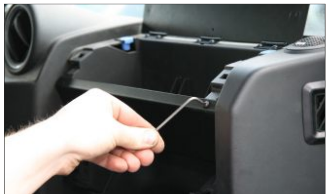
6. Frontplatte montieren (5 Schrauben !)
