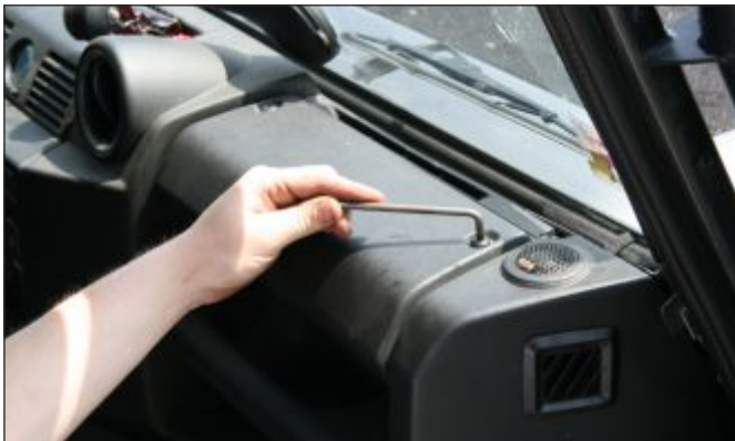
1. Schrauben der Verkleidung lösen
