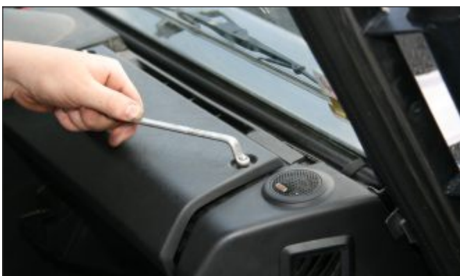
7. Handschuhfachdeckel mit Montageplatte verschrauben
