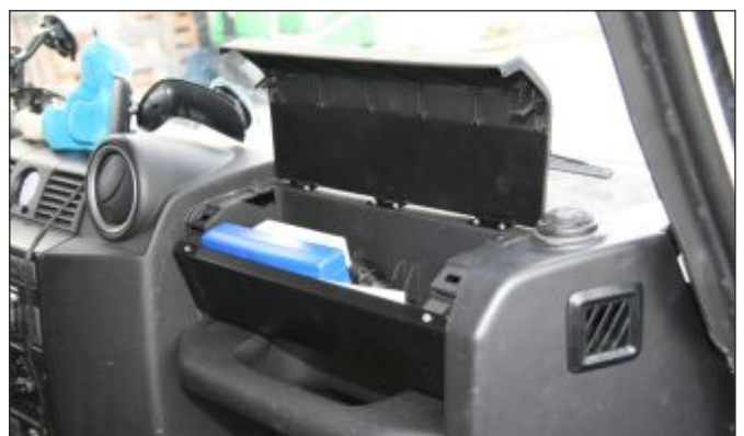
6. Frontplatte montieren (5 Schrauben !)
