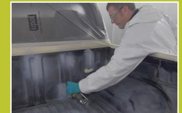
RAPTOR 2K Epoxy Grundierung mit Rostschutz im Aerosol kann für kleinere Flächen nützlich sein.
