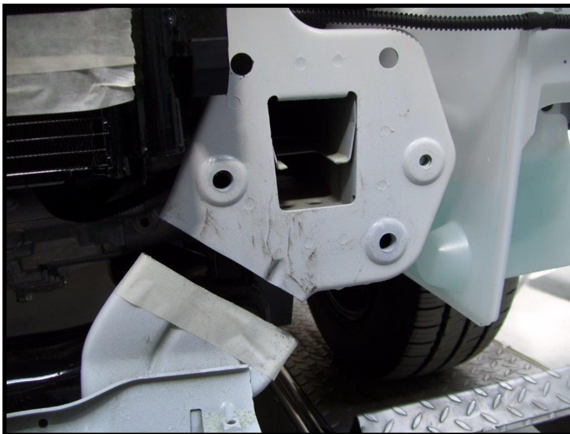
Rozwiercenie otworów \text{Ø}13 z boku. Hole drilling \text{Ø}13 from side.
