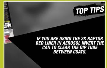
Wenn Sie den 2K RAPTOR Bed Liner verwenden, drehen Sie die Dose um und sprühen die Spritzkanal zur Reinigung leer.
