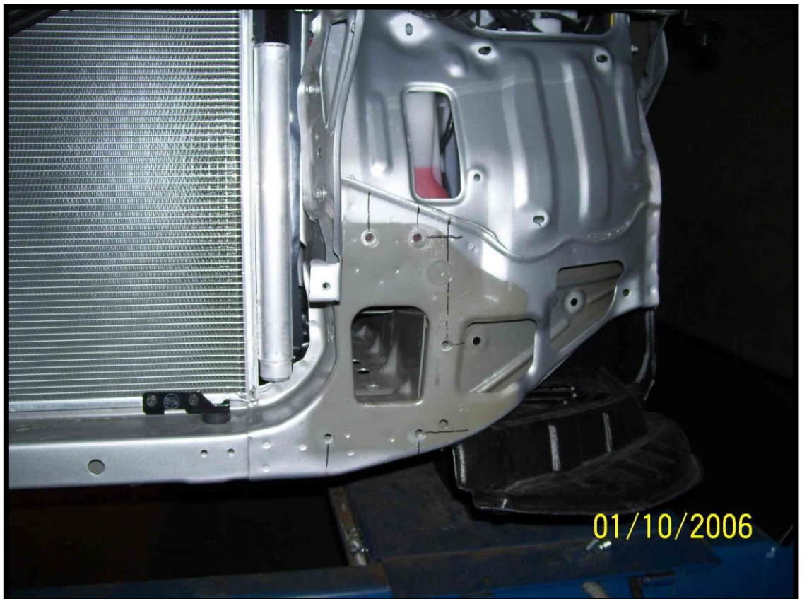
Demontaż zakładek bocznych (strona lewa). Dismantling of overlays (left side).
