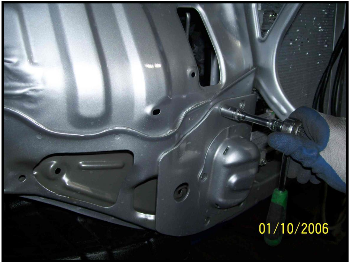
Demontaż zakładek bocznych (strona prawa). Dismantling of overlays (right side).
