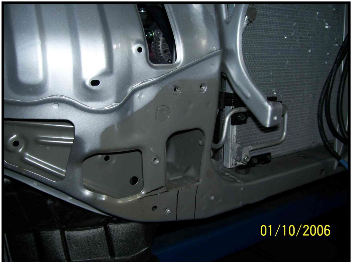
Demontaż zakładek bocznych (strona prawa). Dismantling of overlays (right side).
