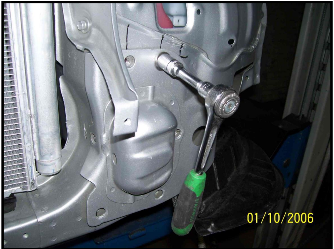
Demontaż zakładek bocznych (strona lewa). Dismantling of overlays (left side).
