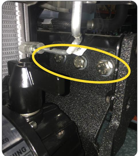
Abb. 11: Befestigung Hauptplatte recht / mounting main plate right
