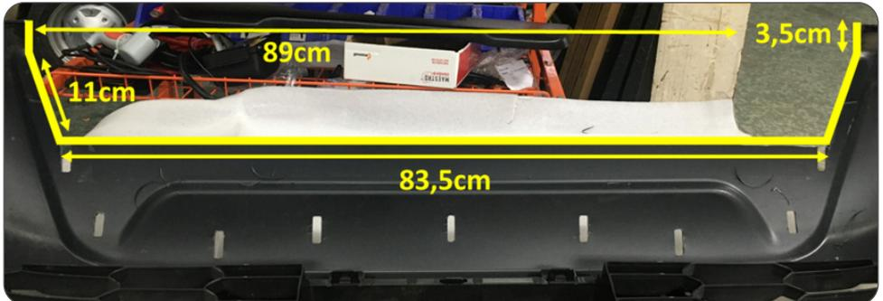
Abb. 22: empfohlener Ausschnitt der Stoßstange/ recommended cut for the bumper
