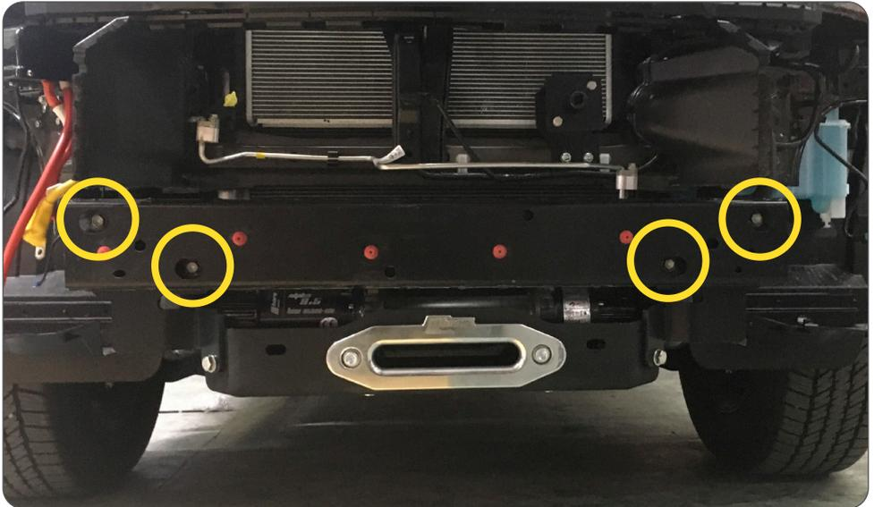
Abb. 18: Befestigung Aufprallschutz / mounting impact bar
