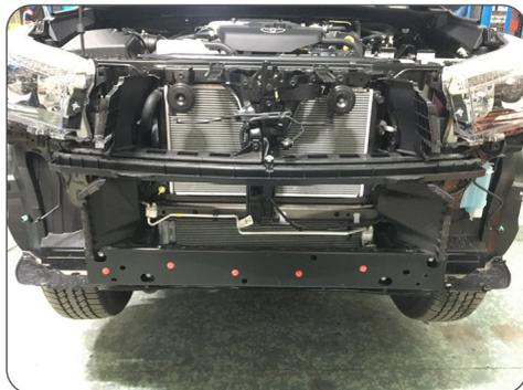
Abb. 4: entfernter vordere Aufprallschutz / removed front impact bar
