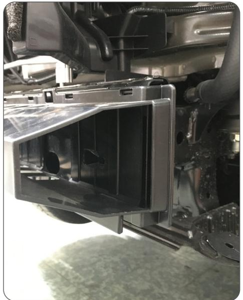
Abb. 2: entfernter Befestigungsclip / removed fastening clip
