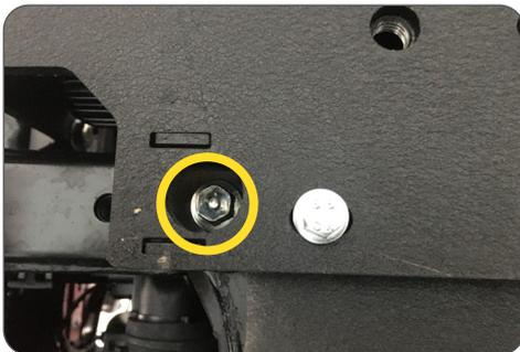
Abb. 13: Befestigung Hauptplatten, unten links / mounting main plate, bottom left
