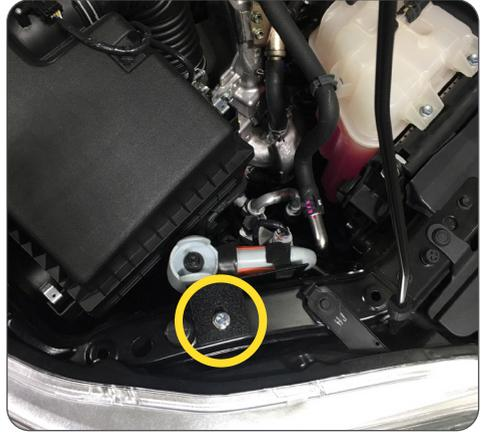
Abb. 21: Befestigung Fernbedienunghalter/ mounting bracket for controller
