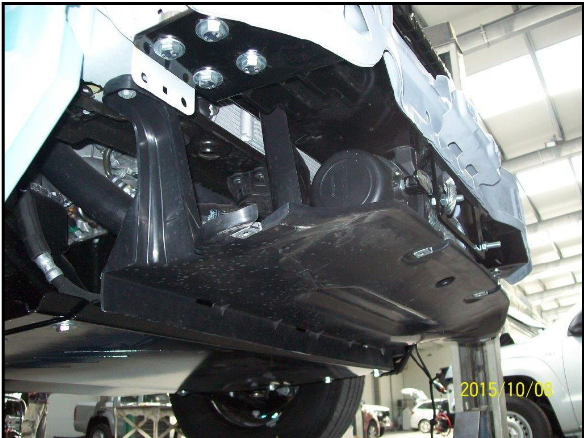
Mocowanie osłony dolnej: Fitting the cover from the bottom::
