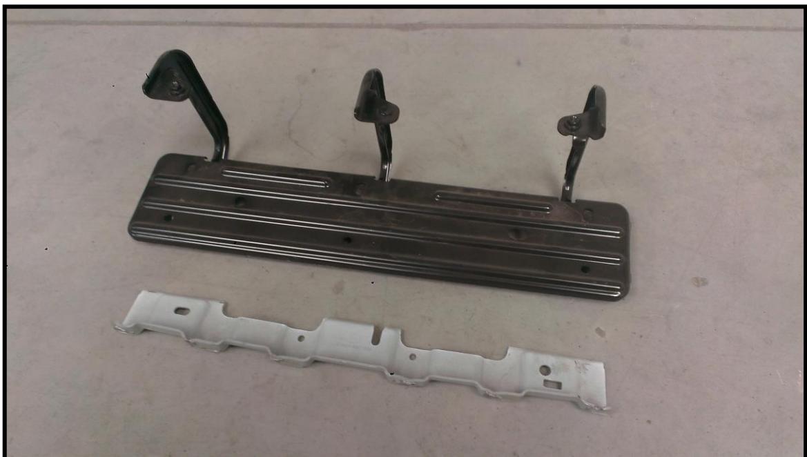
Wymontowanie stopnia przedniego. Removing the front step.
