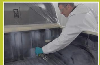
RAPTOR 2K Epoxy Grundierung mit Rostschutz im Aerosol kann für kleinere Flächen nützlich sein.
