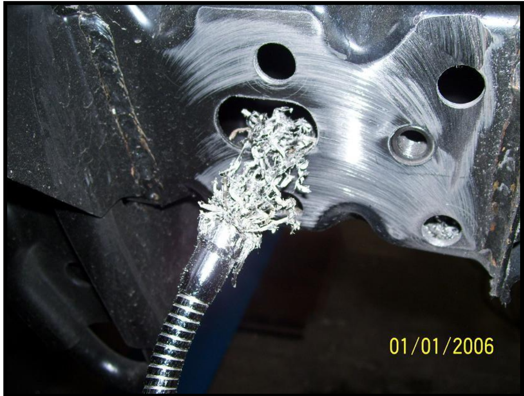
Czyszczenie środka z wiórów i nakładanie podkładu Cleaning the inside of shavings and the imposition primer
