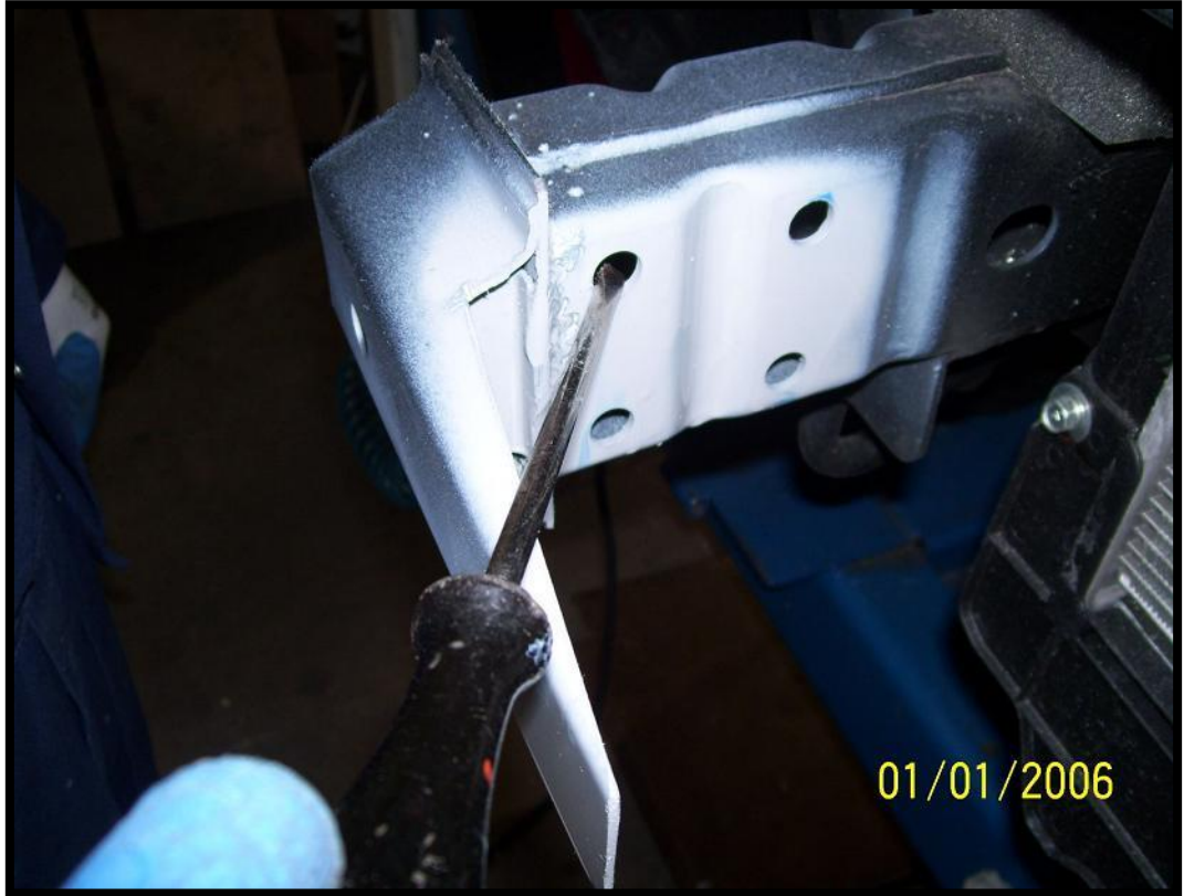
Zakładanie elementów nr. 2 do środka bocznych belek samochodu Inserting an elements no. 2 into the side-car beams
