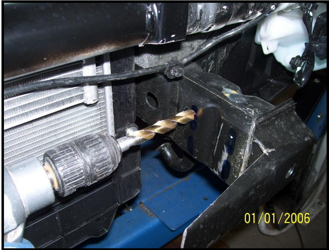
Wiercenie otworów \varnothing 13 i szlifowanie z obu stron The hole drilling \varnothing 13 and grinding from both sides
