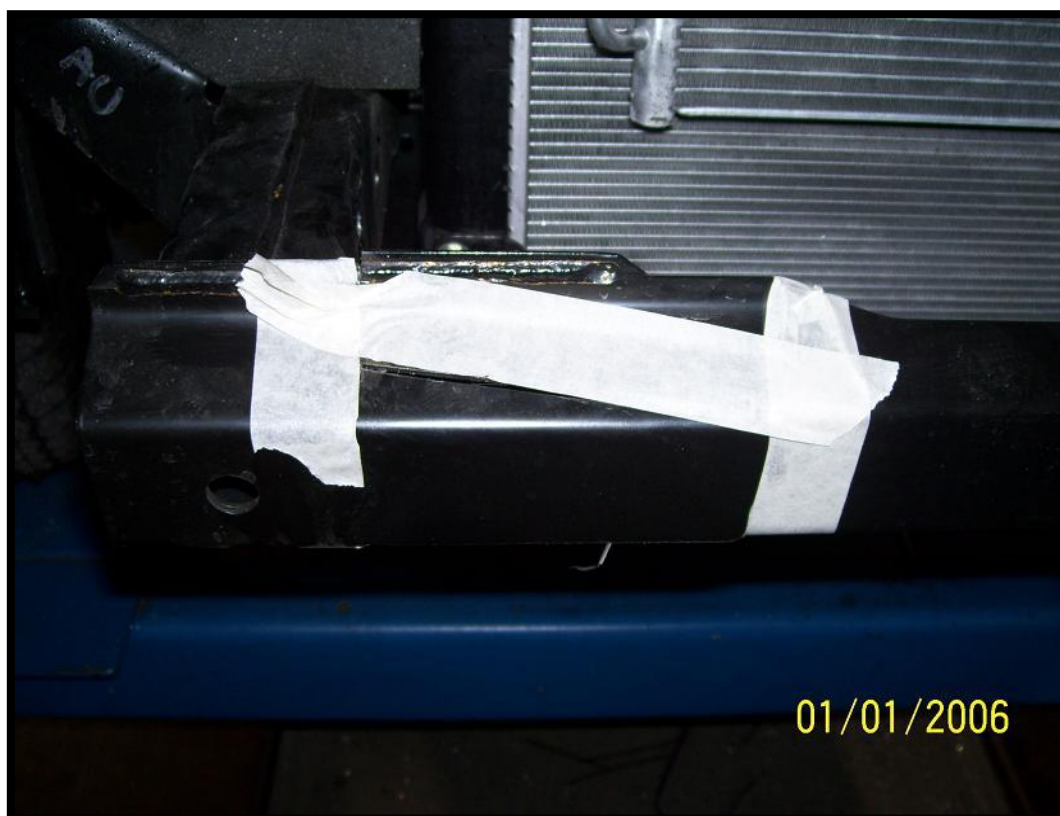
Wycinanie w najwyższej części pasa przedniego: Cut in the highest part of the front beam
