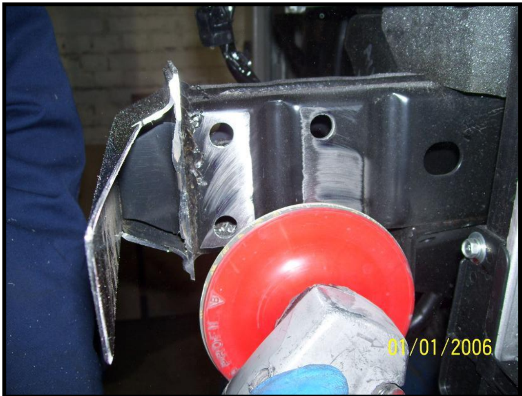
Wiercenie otworów \varnothing 13 i szlifowanie z obu stron The hole drilling \varnothing 13 and grinding from both sides
