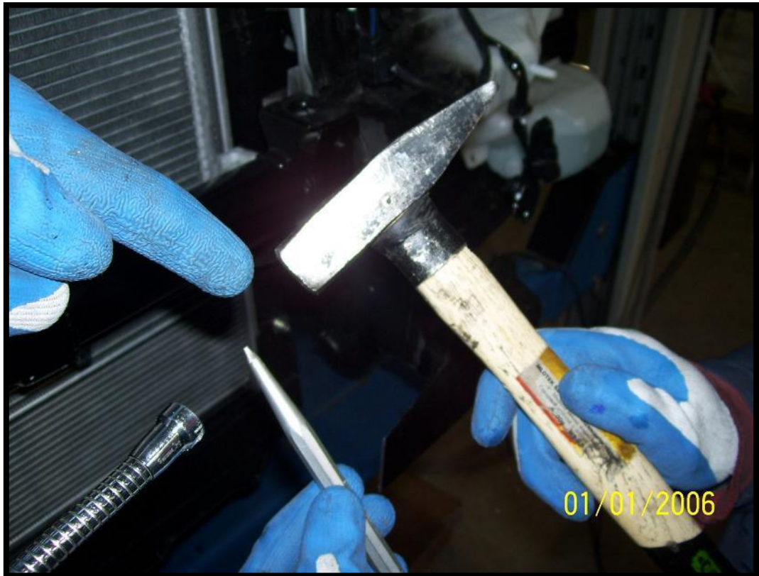
Napunktowanie przed wierceniem Scoring before drilling
