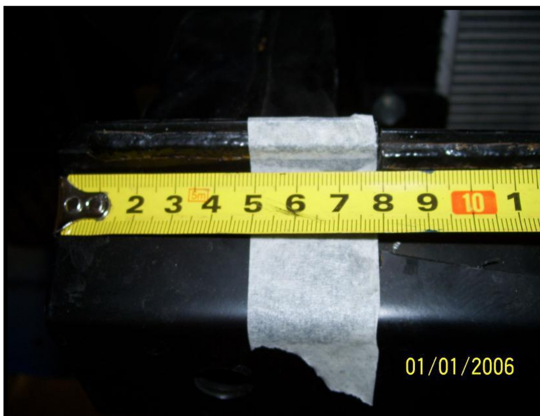
Wycinanie w najwyższej części pasa przedniego: Cut in the highest part of the front beam
