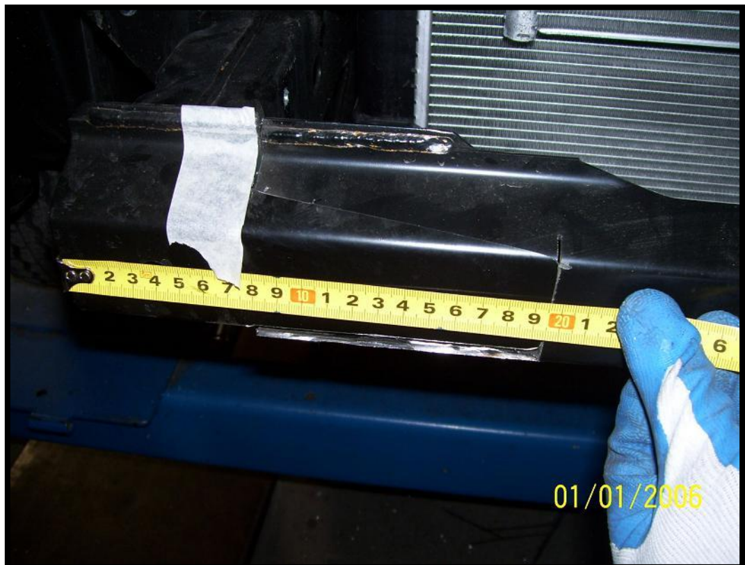
Wycinanie w środkowej części pasa przedniego: Cut in the middle part of the front beam:
