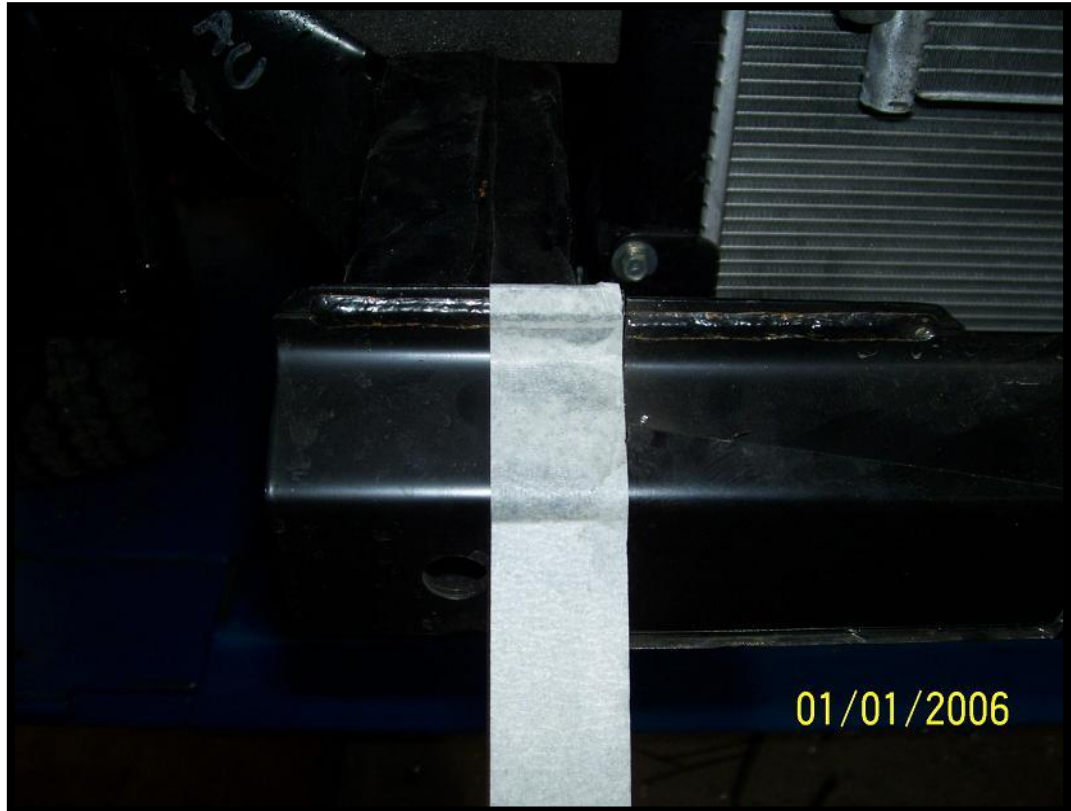
Wycinanie w środkowej części pasa przedniego: Cut in the middle part of the front beam:
