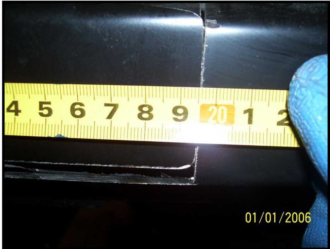
Wycinanie w najniższej części pasa przedniego: Cut in the lowest part of the front beam:
