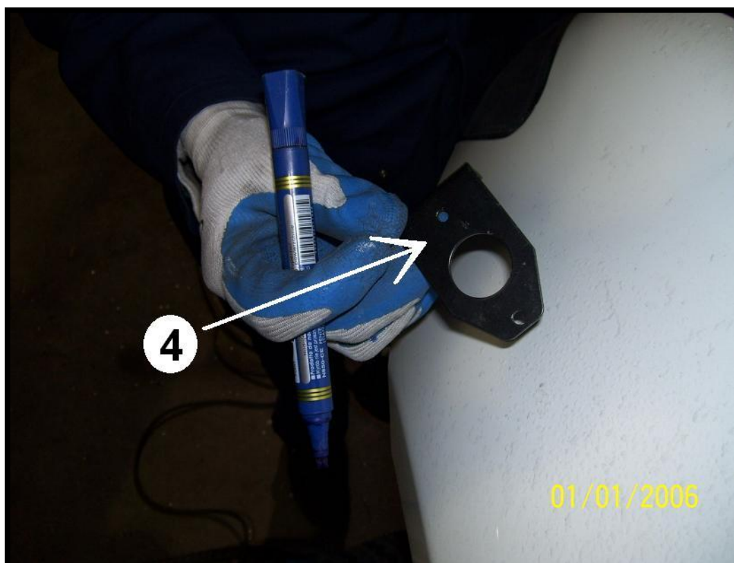
Śruba M6x16 + 2 podkładki Ø 6,5+ nakrętka M6 (x2) Screw M6x16 + 2 washers Ø6,5 + nut M6 (x2)
