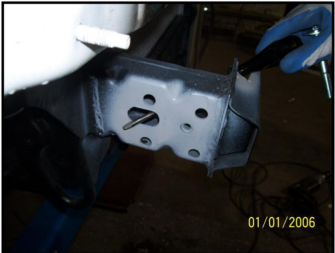
Zakładanie elementów nr. 2 do środka bocznych belek samochodu Inserting an elements no. 2 into the side-car beams
