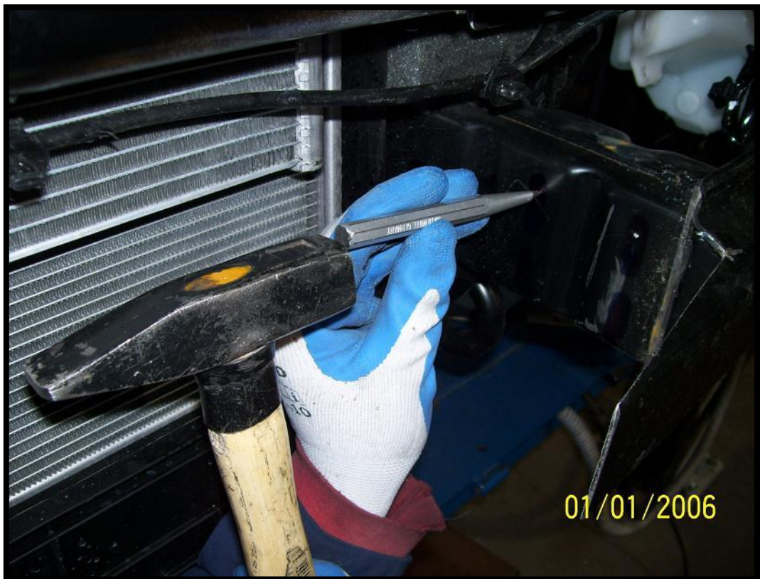
Napunktowanie przed wierceniem Scoring before drilling
