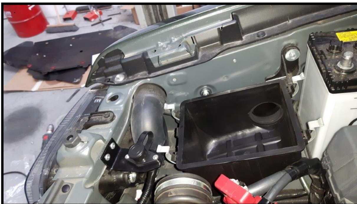
Hebel zabezpieczający (główny wyłącznik prądu) montuje się w dowolnym miejscu pod maską. Security main breaker is mounted anywhere under the hood.
