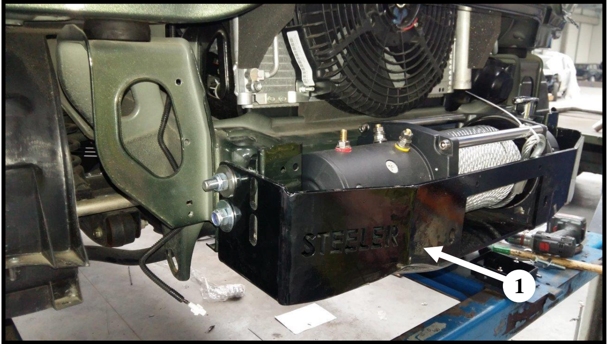
Montowanie przekaźnika. Mounting the relay.
