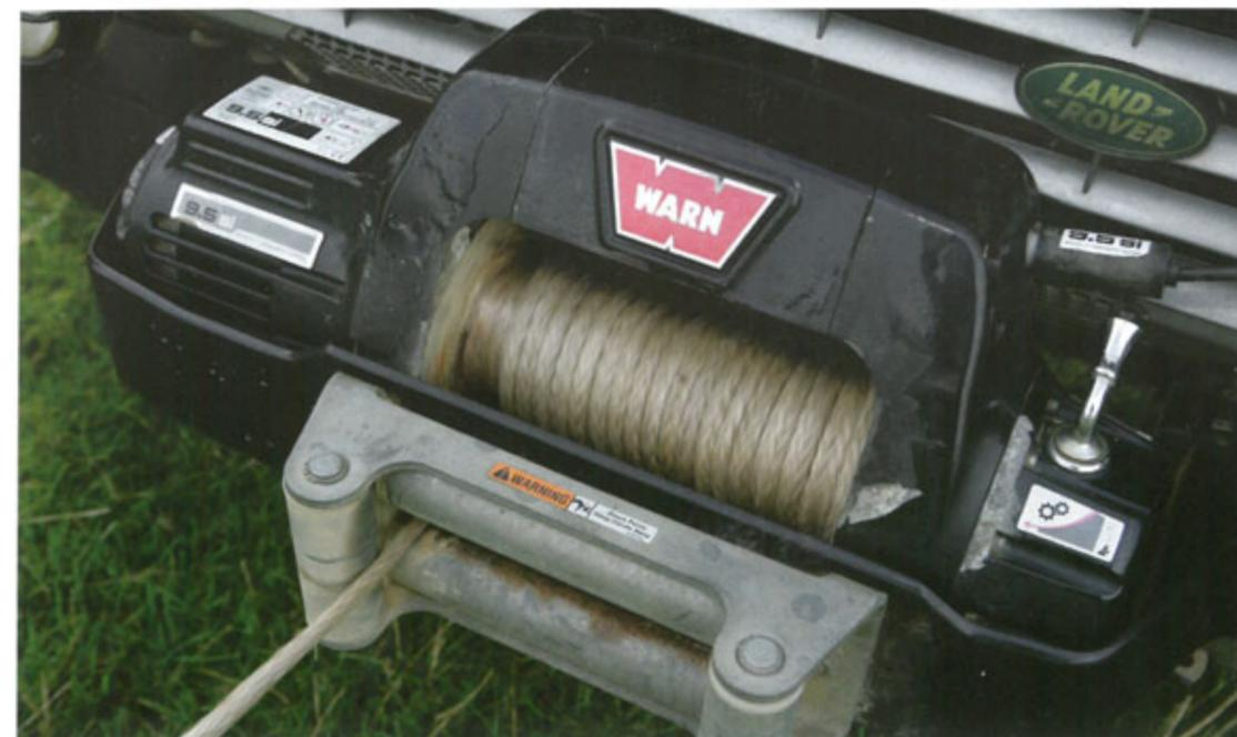
Wir empfehlen eine elektrische Seilwinde mit mindestens 8000 kg Zugkraft und etwa 25 Meter Seil – entweder aus Stahl oder Synthetikfasern. Zudem wird die passende Windenausrüstung benötigt, bestehend aus soliden Handschuhen, ausreichend stabilen Schäkeln, Bodenankern, einem Vorschlaghammer, Baumgurten und einem Flaschenzug.
