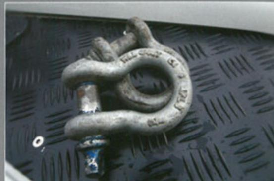
Alle Gurte und Schäkkel müssen mit der zulässigen Traglast beschriftet sein. Bergungsgegenstände ohne einen solchen SWL- (Safe Working Load) oder WLL- (Working Load Limit) Wert dürfen nicht verwendet werden.
